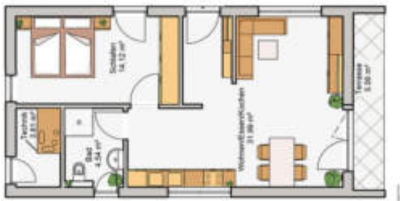
Abbildung 8: Grundriss Tiny House "Singlehaus 54" 46
